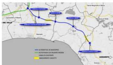
L'intervento riguarda l'ammodernamento di un tratto della statale 115 lungo 23,5 chilometri che dallo svincolo della A29 Castelvetrano giunge allo svincolo di Sciacca Ovest. In particolare, il progetto prevede il raddoppio della carreggiata con due corsie per senso di marcia, undici viadotti da adeguare lungo la carreggiata esistente, undici viadotti di nuova realizzazione per la
